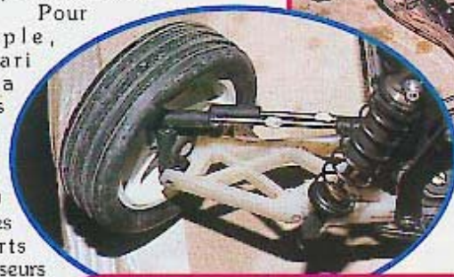
Le Cougar de Steenari et ses triangles avant raccourcis de 5 mm côté châssis.
